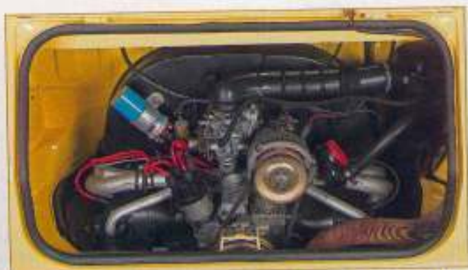
Der 1600er AL-Motor trägt pulverbeschichtete Bleche und den 181er-typischen Gebläsekasten ohne Heizungsanschlüsse.
