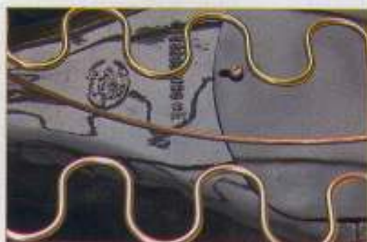
Die Federn sind ebenfalls chromiert und die Enden mit Schrumpfschlauch überzogen.
